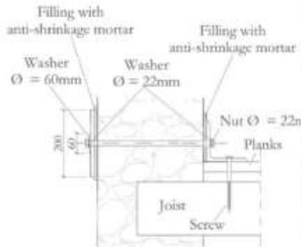
Connessione assito alla muratura
